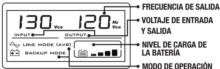
**5. ALARMA AUDIBLE DE BATERÍA EN OPERACIÓN Y BATERÍA BAJA.** Si la línea comercial falla o es inferior a 95 V~ o mayor a 145 V~; se produce un tono audible intermitente para indicar que el equipo está operando con batería. Para indicar el apagado inminente del inversor por haberse agotado la reserva de la batería, el tono audible se volverá continuo durante los últimos minutos.
